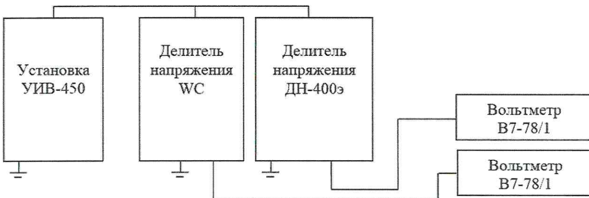
Рисунок 3 - Схема измерений напряжения переменного тока до 400 кВ
