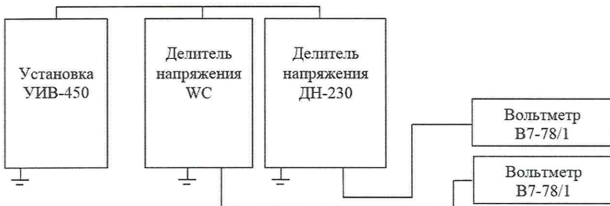
Рисунок 2 - Схема измерений напряжения переменного тока до 200 кВ для модификаций xWCy a/b ref
