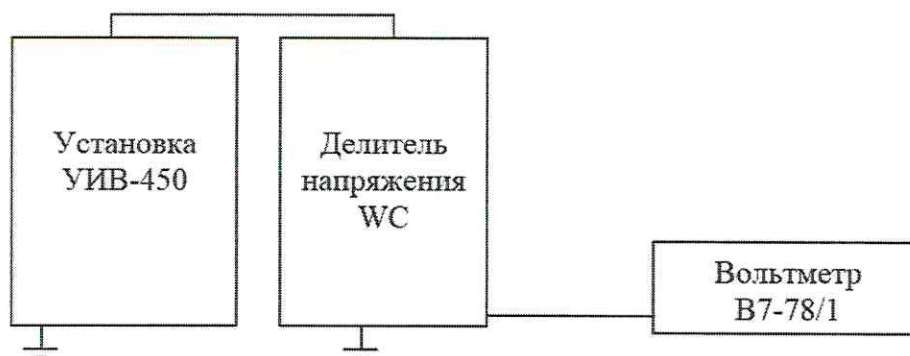
Рисунок 1 - Схема измерений напряжения переменного тока
