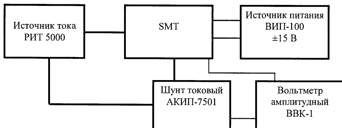
Рисунок 3 - Схема измерения силы тока от 5 до 200 А
