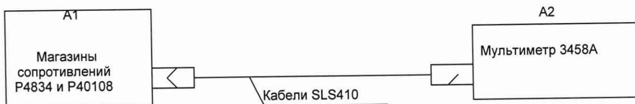
Рисунок 20 – Определение относительной погрешности измерений сопротивления постоянному току
