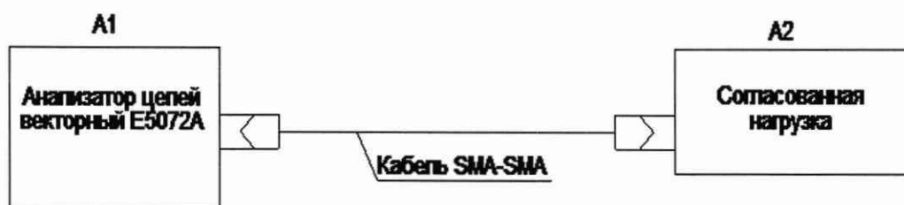
Рисунок 15 – Определение относительной погрешности измерений КСВН
