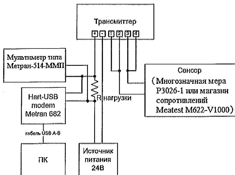
а) для преобразователей с цифровым выходным сигналом на базе протокола HART
