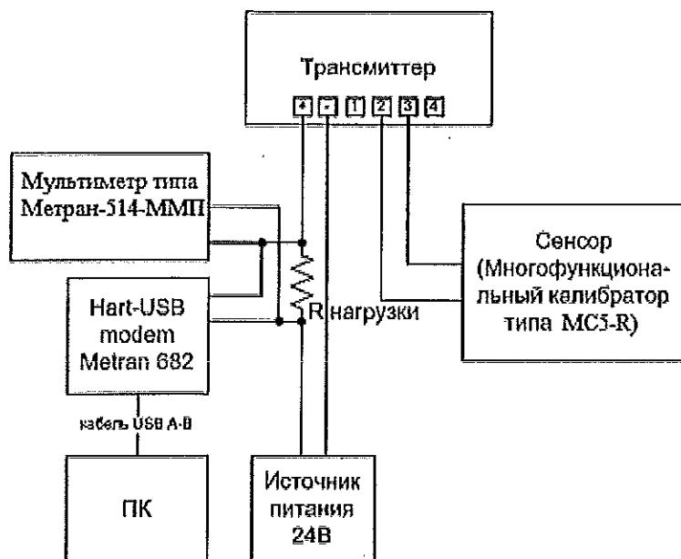
а) для преобразователей с цифровым выходным сигналом на базе протокола HART
