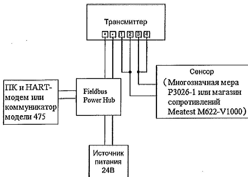
б) для преобразователей с цифровым выходным сигналом Foundation fieldbus или Profibus PA
