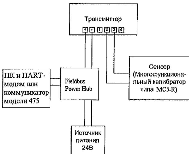
б) для преобразователей с цифровым выходным сигналом Foundation fieldbus или Profibus PA
