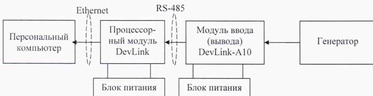
Рисунок А.4.1 – Схема соединений при проверке счёта импульсов (процессорный модуль DevLink в составе с модулями ввода (вывода) DevLink-A10)
