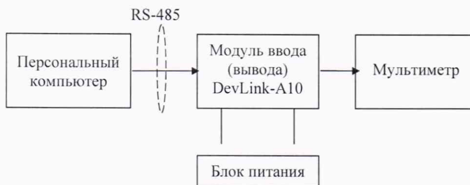
Рисунок А.3.2 – Схема соединений при проверке каналов выдачи тока и напряжения (при наличии только модулей ввода (вывода) DevLink-A10)
