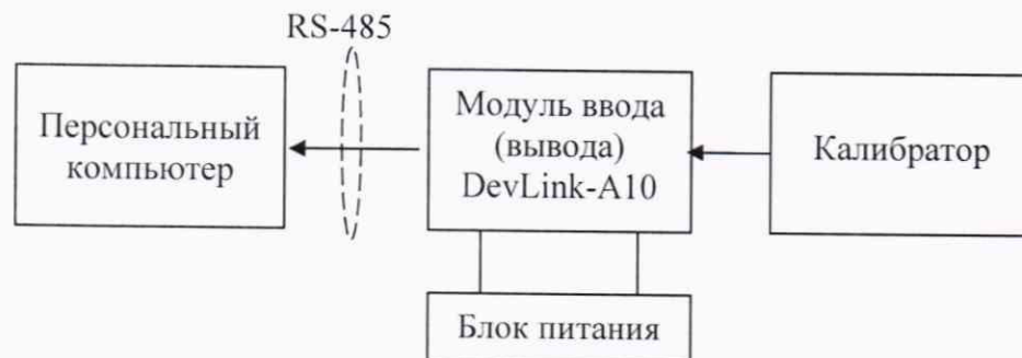
Рисунок А.2.2 – Схема соединений при проверке каналов измерений напряжения, тока, сопротивления и температуры
