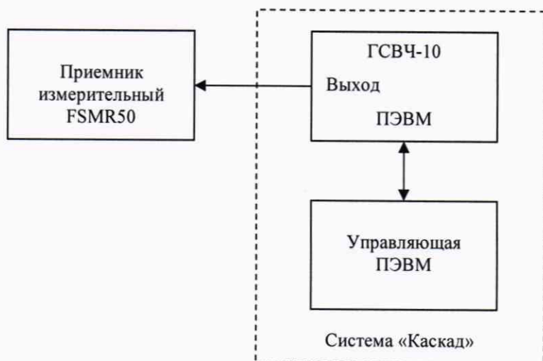
Рисунок 7 – Схема стенда поверки
