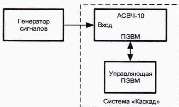
Рисунок 5 – Схема стенда поверки
