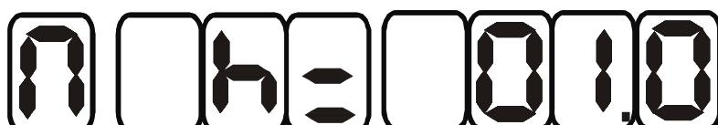
Рис.10. Гистерезис нижнего порога по влажности.
