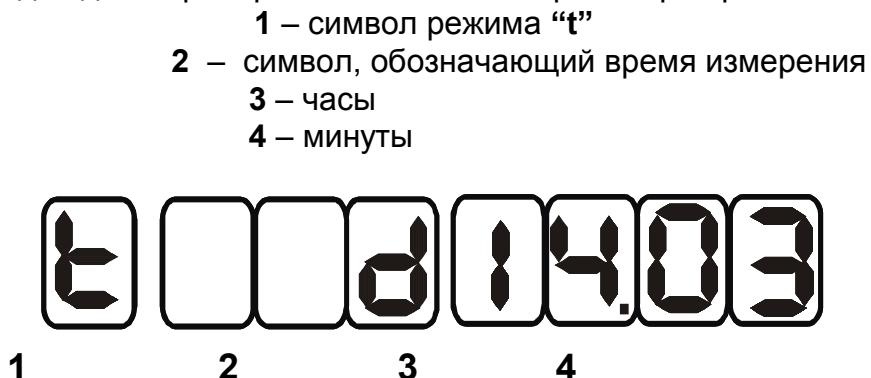
Рис. 18. Вид индикатора в режиме просмотра даты измерения:
