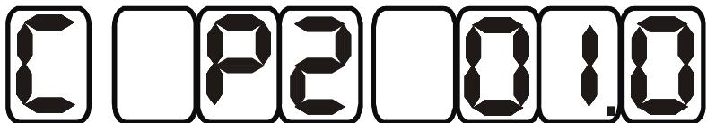
Рис. 14. Значение давления Р2, при котором происходит пересчет величины влажности.
