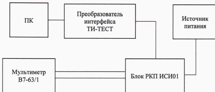
Рисунок 2 - Схема определения абсолютной погрешности воспроизведений напряжения постоянного тока
