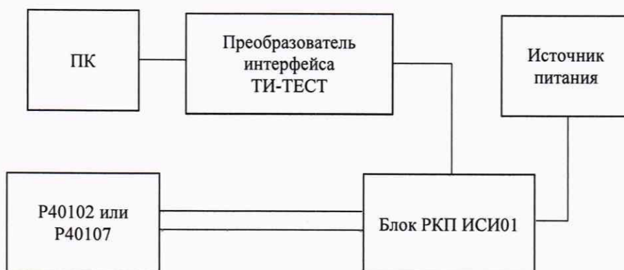
Рисунок 3 - Схема определения относительной основной погрешности измерений электрического сопротивления изоляции
