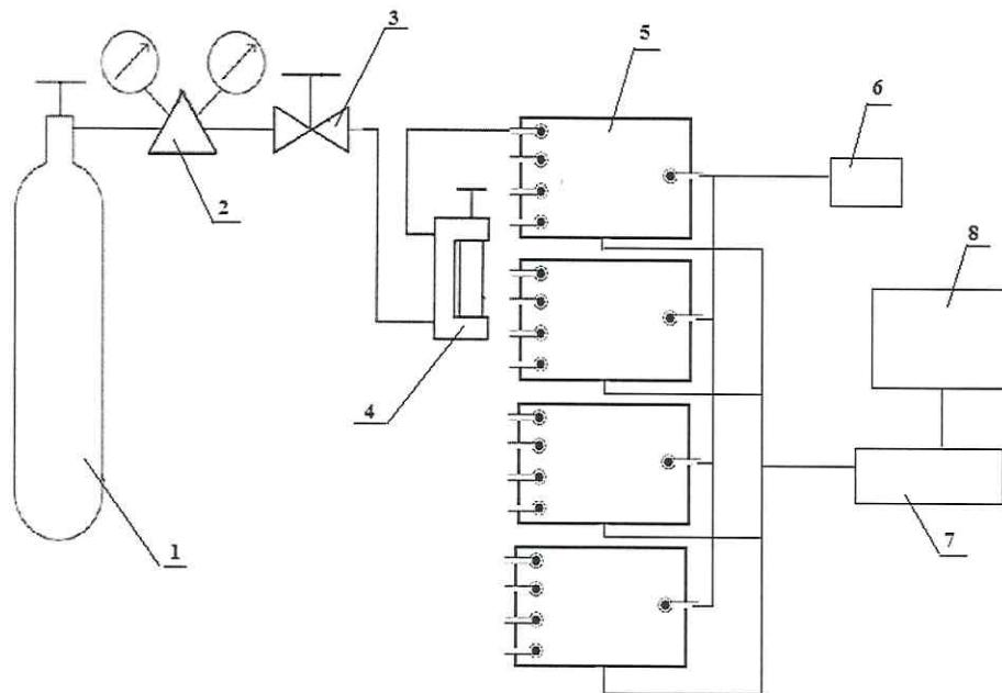
Рисунок Б.1 – Схема подачи ГС, при поверке газоанализатора
