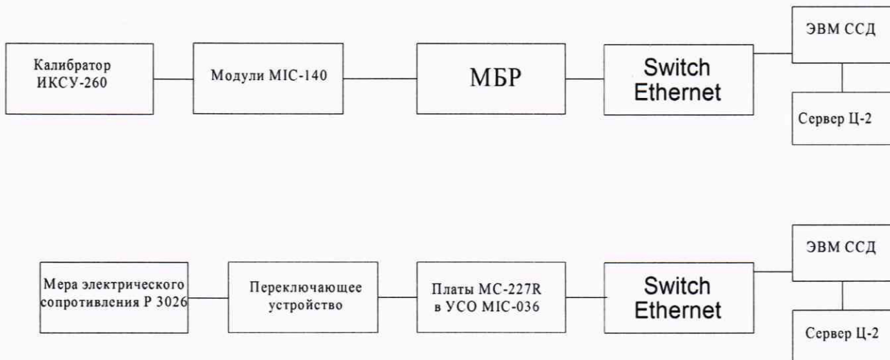
Схема 4 – Поверка ИК напряжения постоянного тока, соответствующего значениям температур газообразных и жидких сред в диапазоне преобразований ПП термоэлектрического типа; ИК сопротивления постоянному току, соответствующего значениям температур газообразных и жидких сред в диапазоне преобразований ПП терморезистивного типа.
