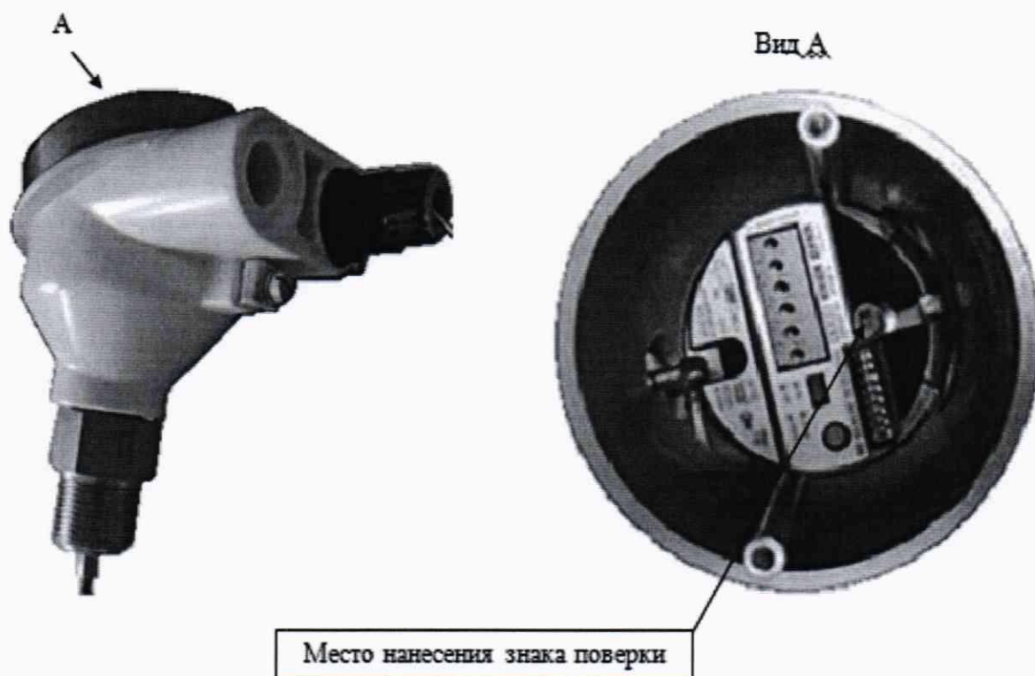
б) схема пломбирования уровнемера без показывающего устройства
