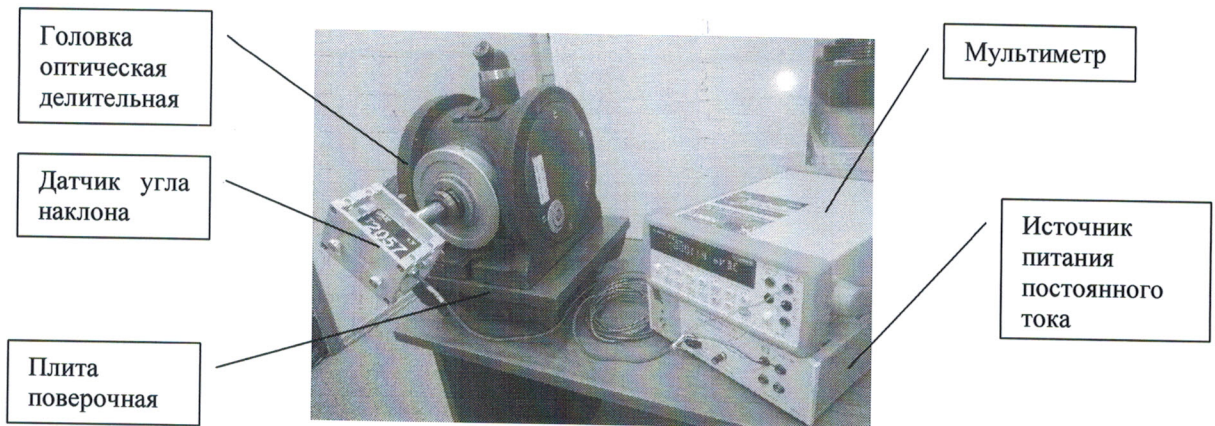
Рис. 3. Блок – схема поверки датчиков угла наклона T410-X600, T420-X600-Y600 и T500-600
