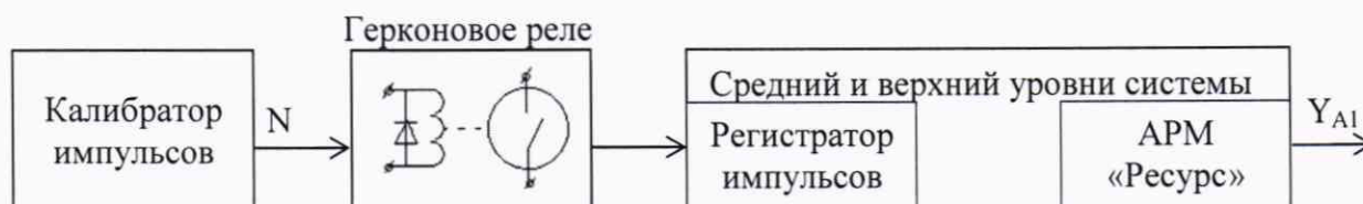
Рисунок 1 - Схема соединений при определении МХ среднего и верхнего уровней системы с ПУ, оснащенным импульсным выходом
