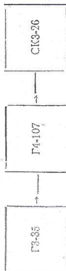
Рис. 8. Структурная схема измерения девиации частоты генератора в режиме внешней частотной модуляции.
