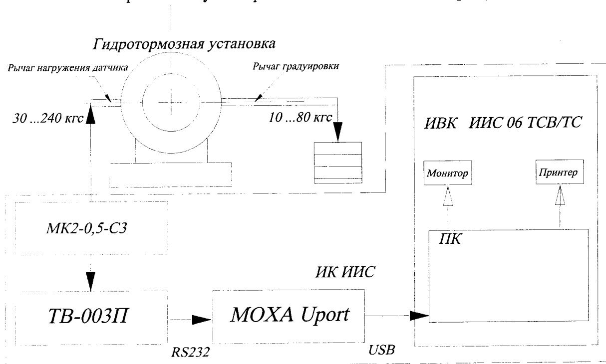
Рисунок 12 – Схема определения МХ ИК силы крутящего момента при поверке
