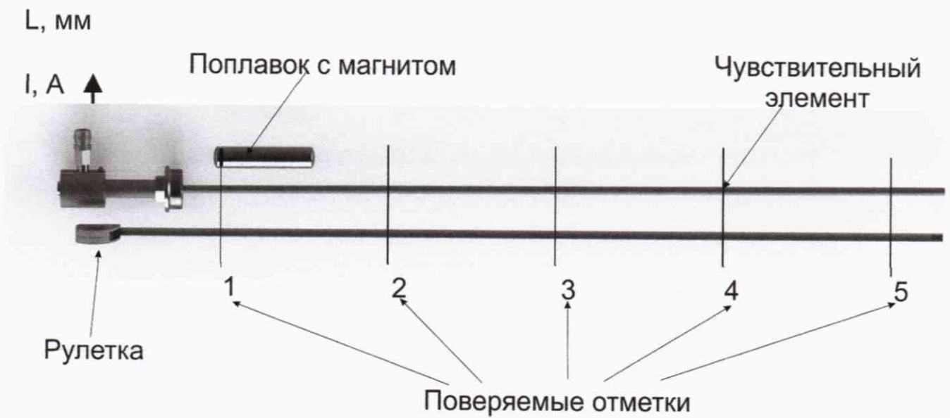
Рисунок 3 – Поверка уровнемера с помощью рулетки и магнитного поплавка
