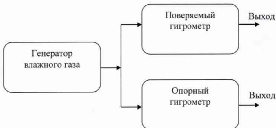
Рис. 1. Схема подключения гигрометров к генератору влажного газа. Стрелками указано направление потока газа.
