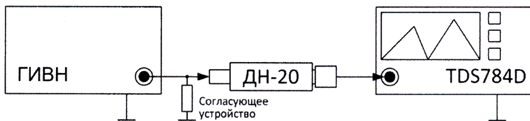
Рисунок 2 – Схема измерений при определении коэффициента преобразования делителя
