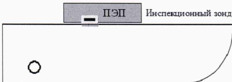
Рисунок 8 – Схема для поверки на мере №3Р
