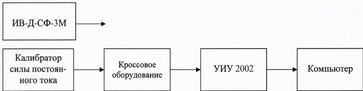
Рисунок Б.6 - Схема определения метрологических характеристик ИК виброскорости
