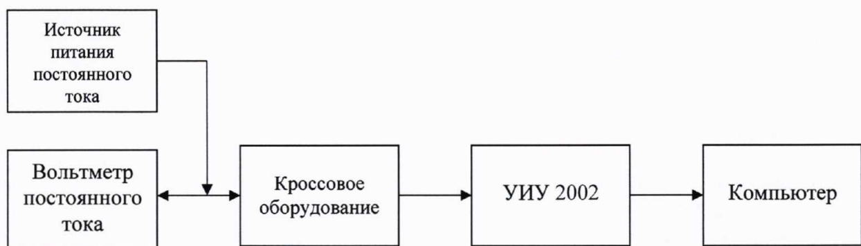
Рисунок Б.8 - Схема определения метрологических характеристик ИК напряжения постоянного тока
