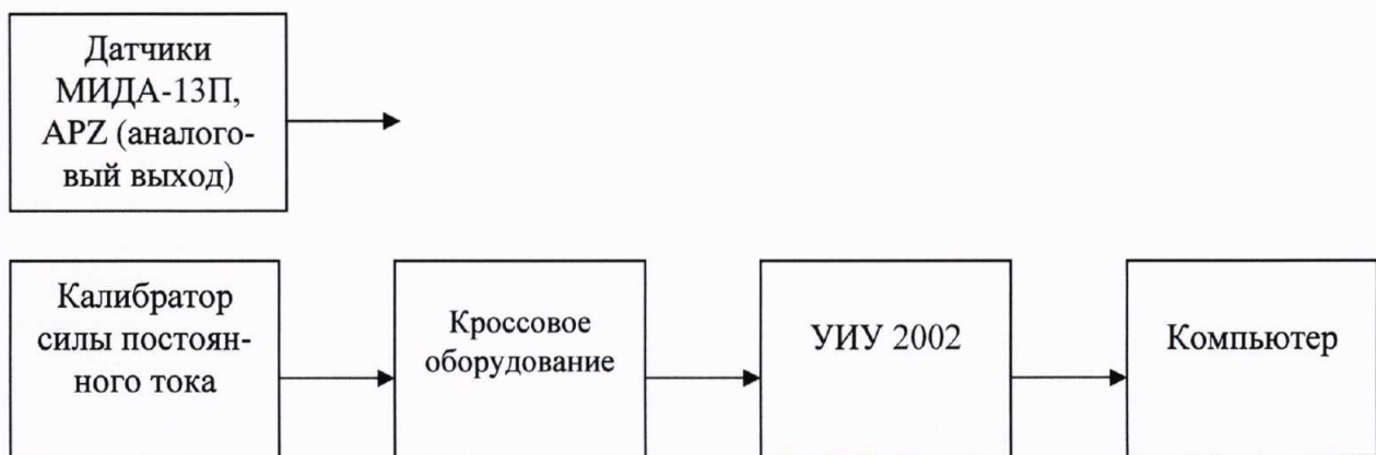
б) Схема определения метрологических характеристик поэлементным способом
