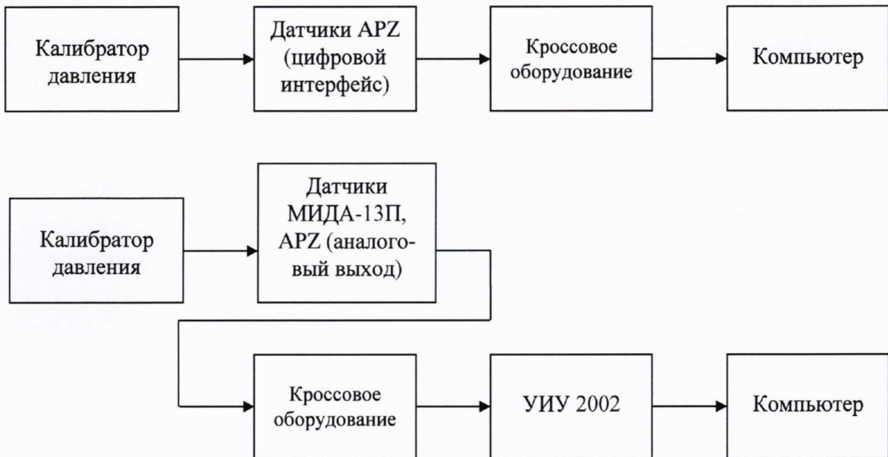
а) Схема определения метрологических характеристик комплектным способом
