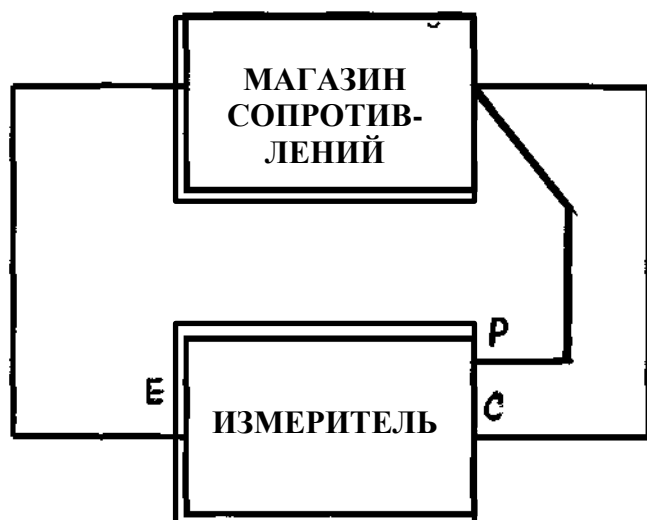
Рисунок 1 Схема соединений при проверке погрешности в режиме измерения сопротивления заземления
