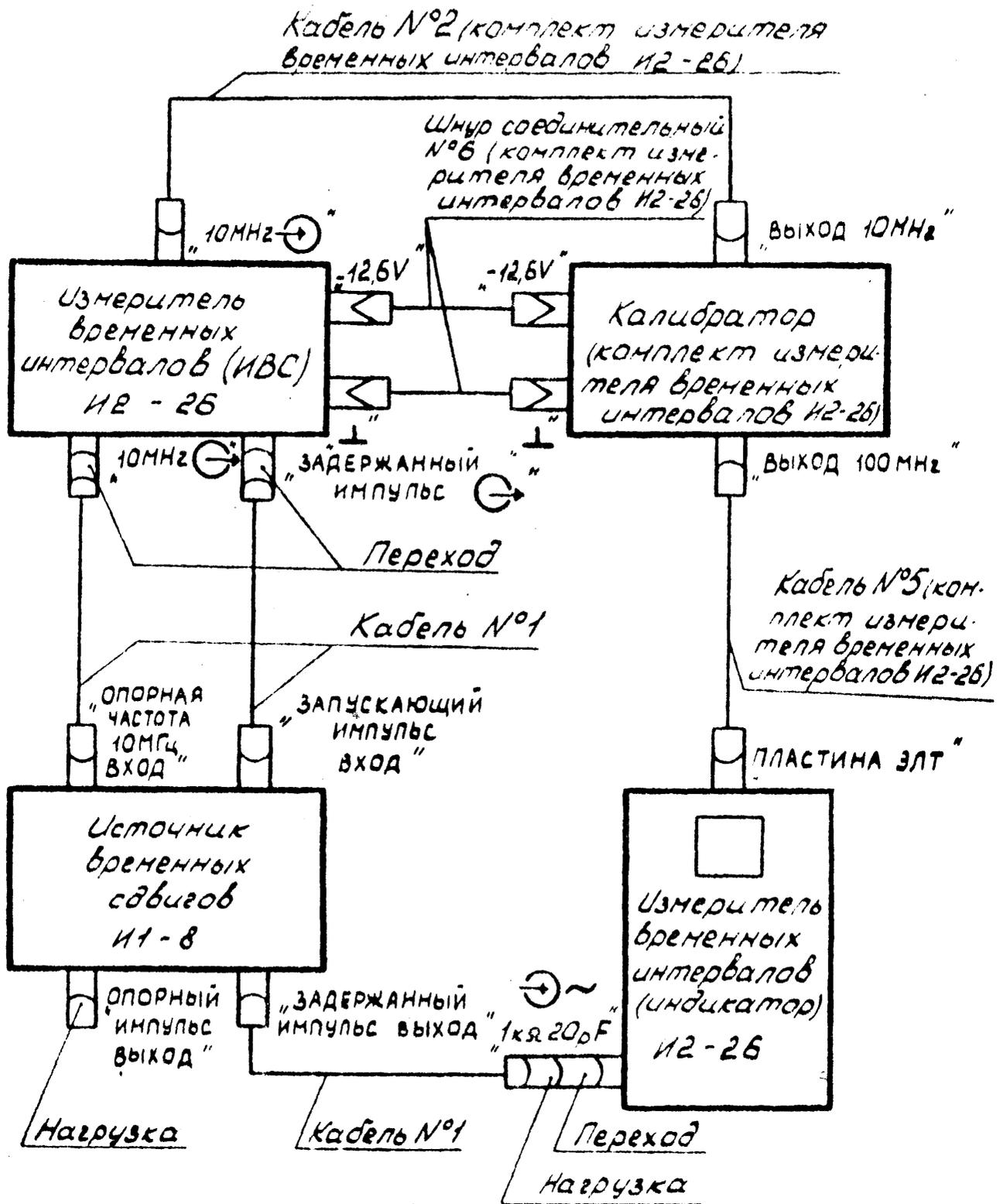
Рис.17 Схема соединения приборов для определения погрешности изменения временного положения задержанного импульса в диапазоне 0 - 999999900 нс
