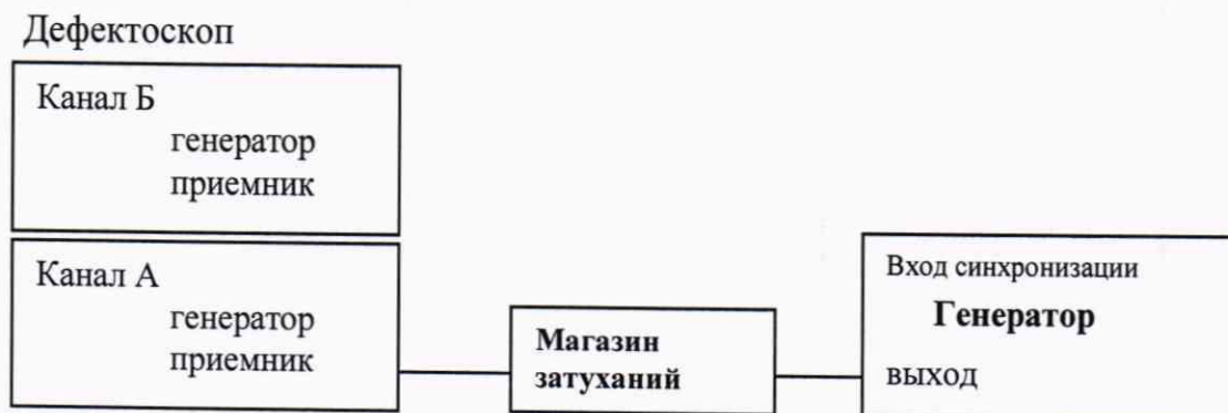
Рисунок 5 – Схема соединения для определения абсолютной погрешности измерений амплитуд сигналов на входе приемника
