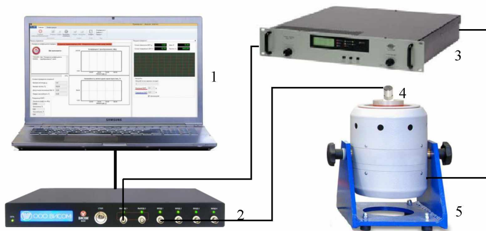
1 – ПЭВМ; 2 – ВС-301; 3 – усилитель мощности; 4 – вибропреобразователь AP10; 5 – вибростенд
