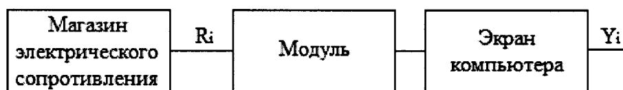
Рисунок 2 - Схема подключений при определении погрешностей ИК, реализующих аналого-цифровое преобразование сигналов от термопреобразователей сопротивления
