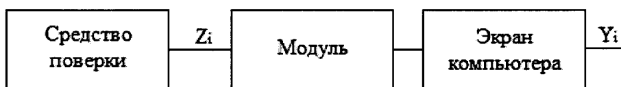
Рисунок 1 - Схема подключений при определении погрешностей ИК, реализующих линейное аналого-цифровое преобразование сигналов силы или напряжения постоянного электрического тока, электрического сопротивления, частоты следования импульсов
