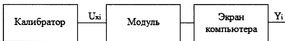
Рисунок 3 - Схема подключений при определении погрешностей ИК, реализующих аналого-цифровое преобразование сигналов от термопар
