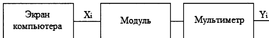
Рисунок 4 - Схема подключений при определении погрешностей ИК, реализующих линейное цифро-аналоговое преобразование сигналов силы и напряжения постоянного электрического тока
