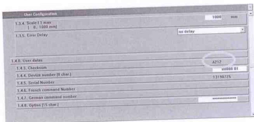
Уровнемер считаю годным, если номер версии программного обеспечения и контрольная сумма соответствует приведенному в разделе 1.3.8 РЭ.
