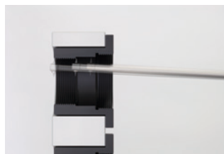
Двухсторонний щуп для измерений в направлениях вверх и вниз
