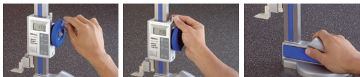
Регулирующее колесико Стопорный рычаг ползунка Эргономичная опора
