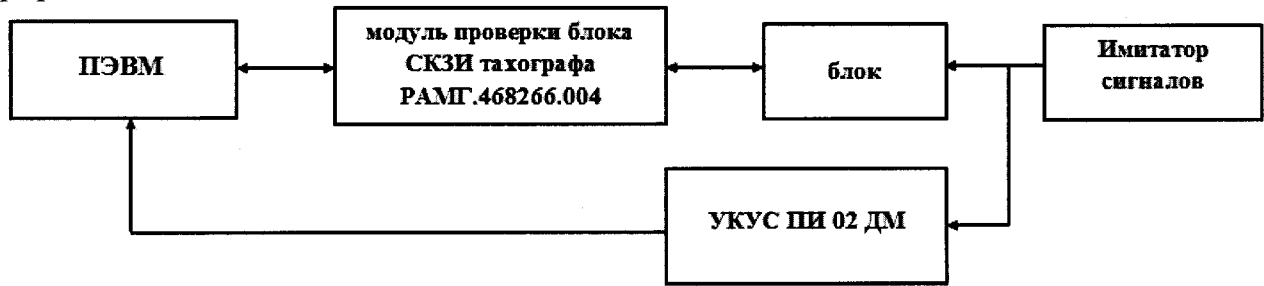
Рисунок 2 – Схема проведения измерений при определении абсолютной погрешности синхронизации, абсолютной инструментальной погрешности определения координат местоположения, абсолютной погрешности определения скорости
