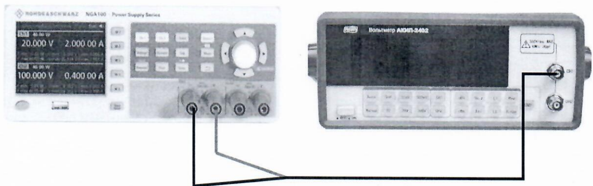
Рисунок 3 – Структурная схема соединения приборов для определения уровня пульсаций выходного напряжения постоянного тока
