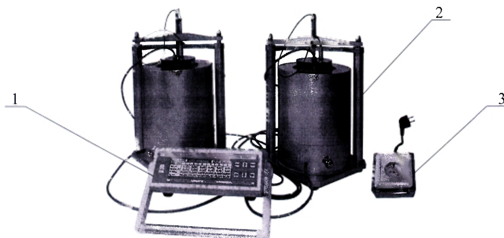
1 – электронный блок 2 – термоконтейнер 3 – РХ
