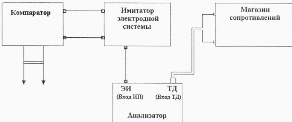
(ЭИ – электрод измерительный (или комбинированный); ТД – термодатчик;
