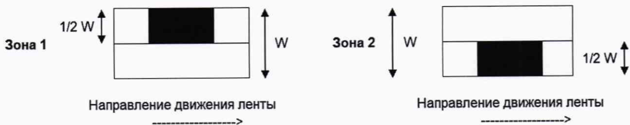
Рисунок 1 — Расположение испытательных нагрузок при оценке погрешности при автоматическом взвешивании объектов измерений при их нецентрированном положении при движении по конвейеру
