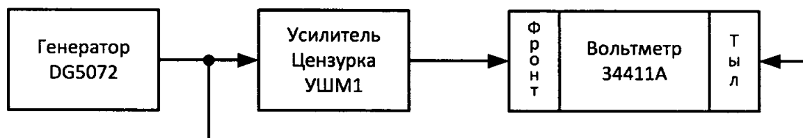
Рисунок 6.2 Схема соединения приборов при определении коэффициентов усиления от 0 до 40 дБ.
