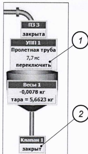
Рисунок Б.3 – Фрагмент базового окна программы, показывающий элементы, необходимые для измерения времени переключения УПП
