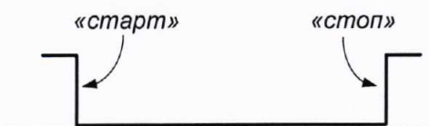
Рисунок В.2 – Форма сигналов «старт» и «стоп»
