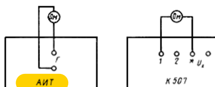
Рис.1. Схема проверки исправности электрической цепи реохордов. Ом - комбинированный прибор Ц4312 (Ц434) класса точности 1 с пределом измерения 0,2 (0,5) кОм
