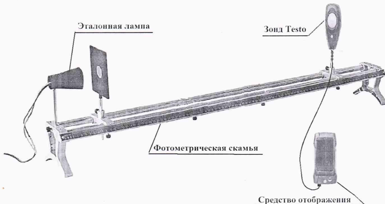
Рисунок 8 – Схема установки зонда Testo на фотометрической скамье
