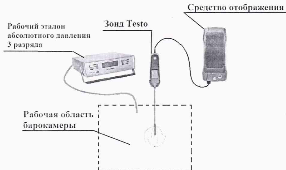
Рисунок 6 – Схема определения абсолютной погрешности измерений абсолютного давления
