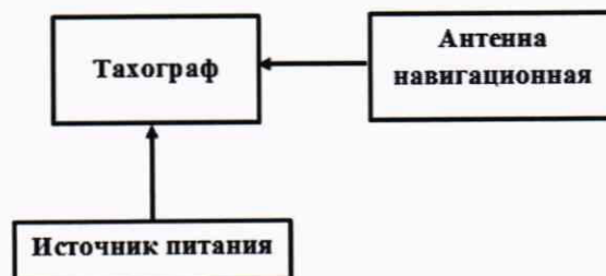
Рисунок 1 – Схема проведения измерений при опробовании
