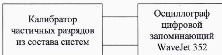
Рисунок А.3 - Схема структурная определения приведенной к диапазону воспроизведений погрешности воспроизведений кажущегося заряда (при использовании калибратора частичных разрядов из состава систем)
