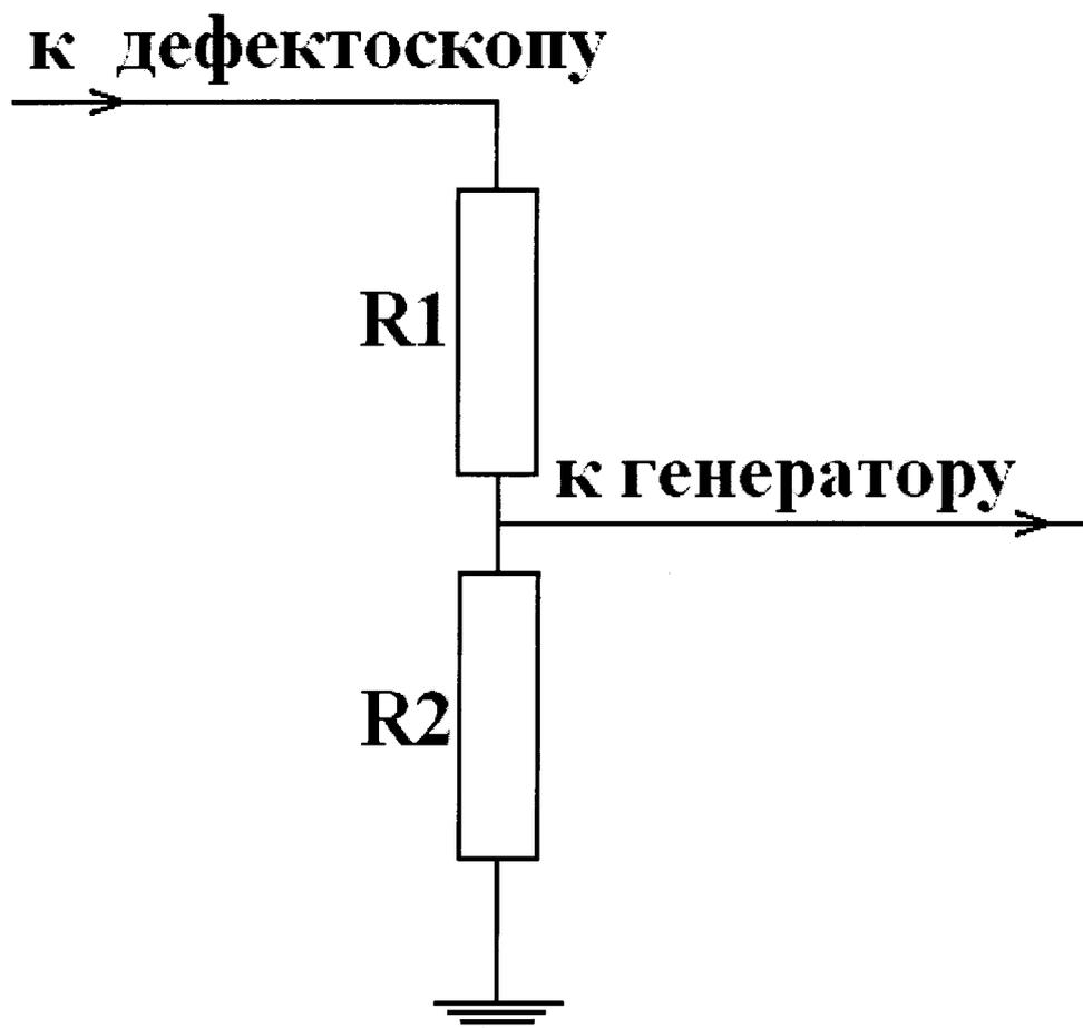
Для защиты канала синхронизации генератора от высокого напряжения с выхода канала дефектоскопа используется согласующее устройство.
