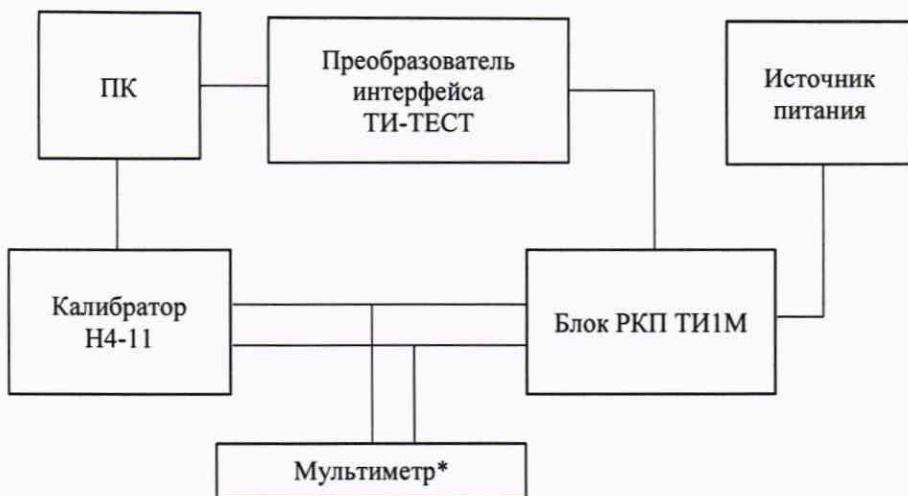
Примечание – использовать мультиметр В7-63/1 для контроля напряжения переменного тока выше 150 В (в диапазоне частот от 20 до 40 Гц), мультиметр цифровой Fluke 8808A для контроля частоты переменного тока
