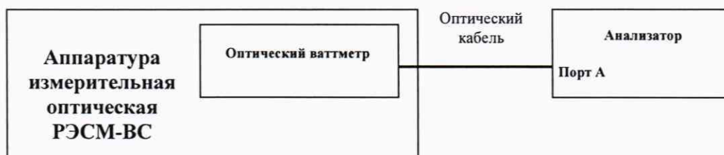
Рисунок 11 – Схема установки для определения уровней мощности выходных сигналов на оптических интерфейсах анализатора
