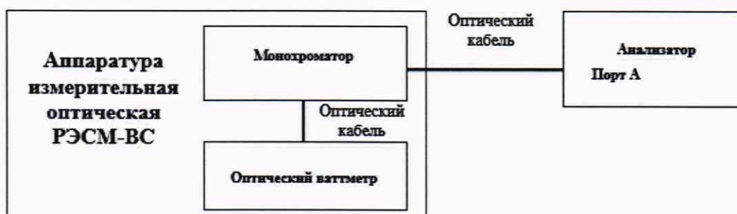
Рисунок 10 – Схема установки для определения центральных длин волн лазеров оптических интерфейсов анализатора
