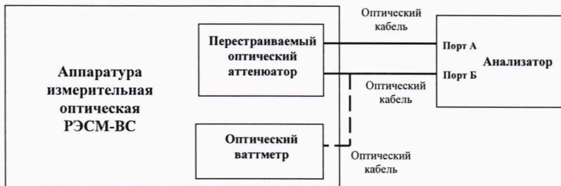
Рисунок 12 – Схема установки для определения минимальной входной мощности на оптических интерфейсах анализатора
