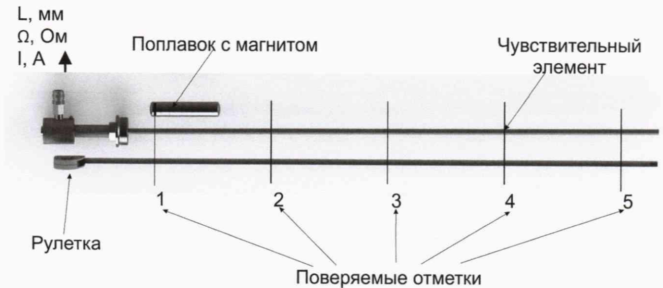
Рисунок 2 – Проверка преобразователя без демонтажа с помощью эталонной рулетки с лотом
