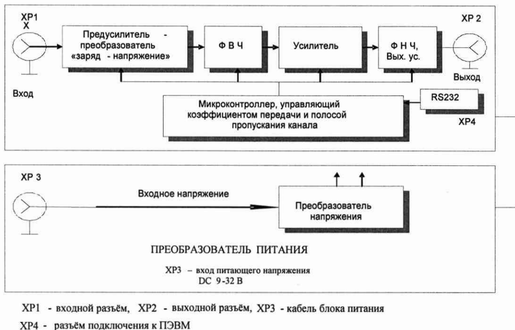
Рисунок 4.1 - Структурная схема взаимодействия составных частей PSH2731Э85
