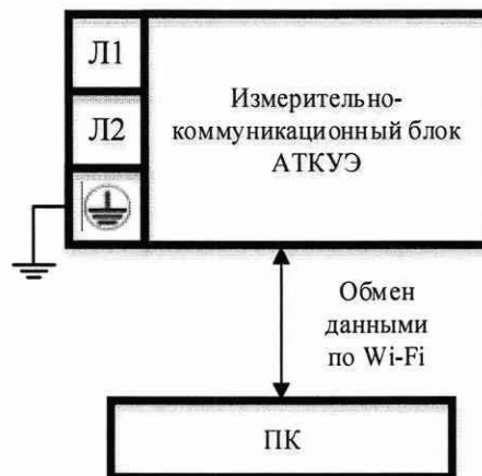
Рисунок 4 – Структурная схема для подтверждения программного обеспечения АТКУЭ
