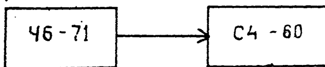
Рис. 11. Структурная схема измерения комбинационных составляющих спектра выходного сигнала.
