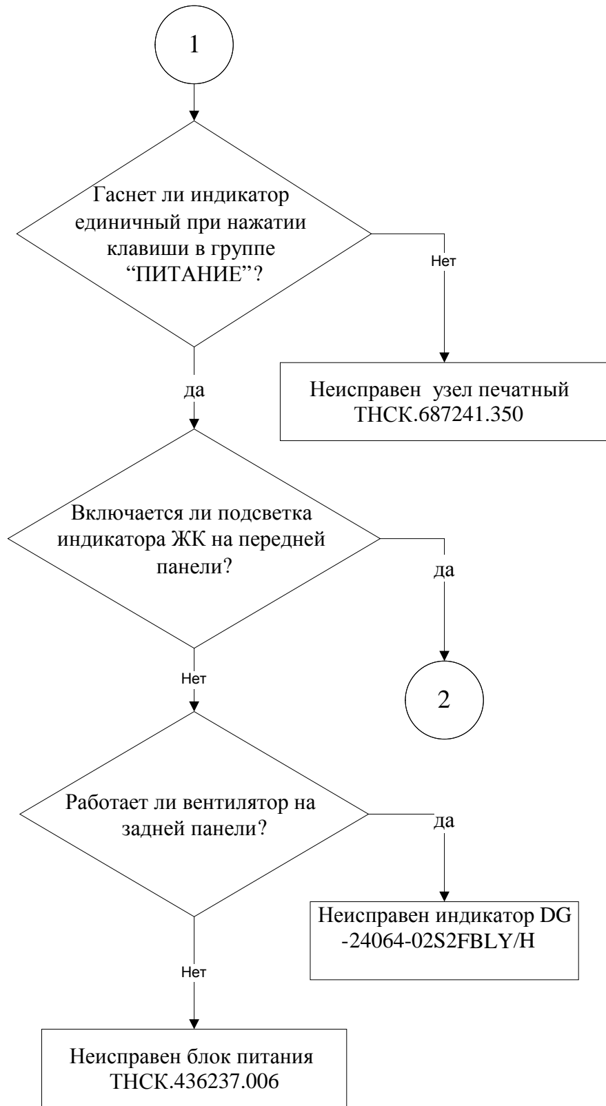
Рисунок 8.1 б – Схема алгоритма диагностирования по поиску неисправностей генератора сигналов высокочастотного Г4-232 (продолжение рисунка 8.1 а)
