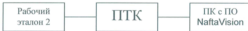
Рисунок 6 - Структурная схема подключения ПТК для проверки пределов абсолютной погрешности при измерении количества импульсов.
