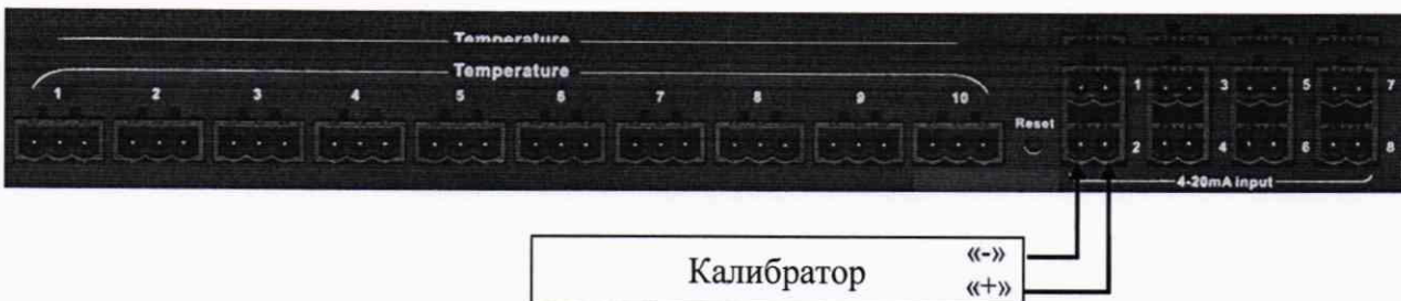
Рисунок 9 – Структурная схема определения относительной погрешности измерений силы постоянного тока
