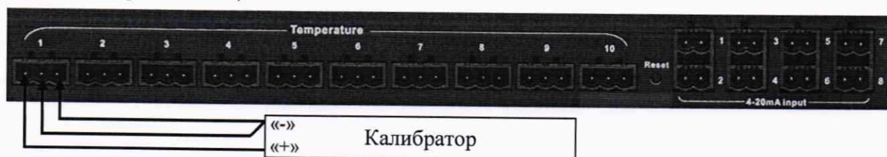
Рисунок 5 – Структурная схема определения относительной погрешности измерений сигналов от термопреобразователей сопротивления
