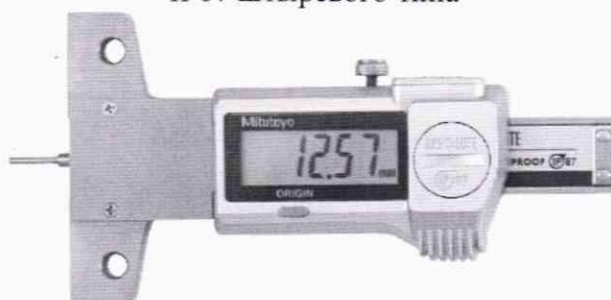
Рисунок Б.5 - Общий вид штангенглубиномеров серии 571 модификации ABSOLUTE Digimatic для протекторов шин
