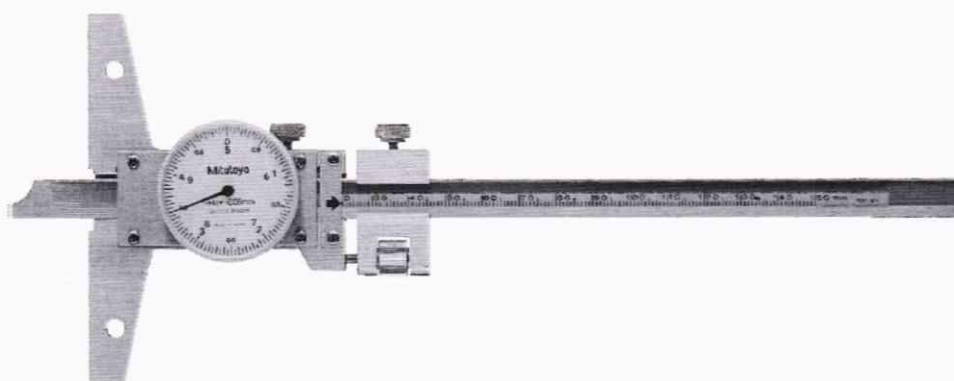
Рисунок Б.10 - Общий вид штангенглубиномеров серии 527 модификации с круговой шкалой
