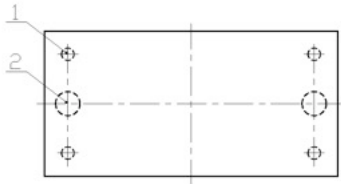
1 - датчики весов, 2 - зона установки образцового динамометра
